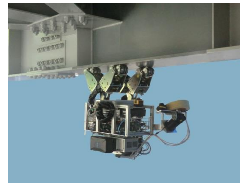
名古屋大実験施設(N2U-BRIDGE)での走行実験と指向性音カメラによる計測結果
