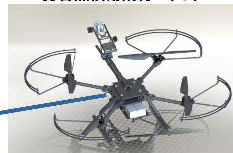
打音点検用飛行ロボット
