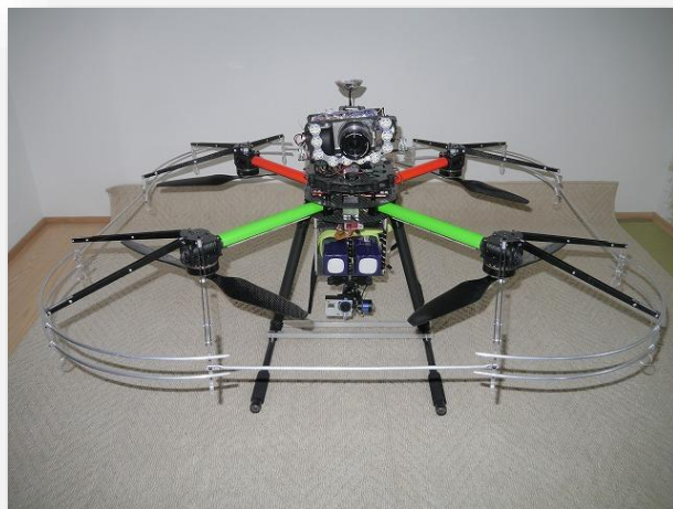
下部工(床版)撮影仕様機体
