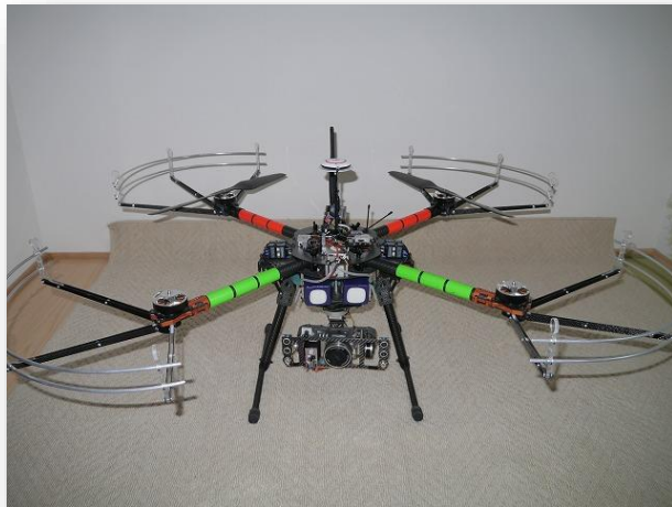
上部工(橋面)撮影仕様機体
